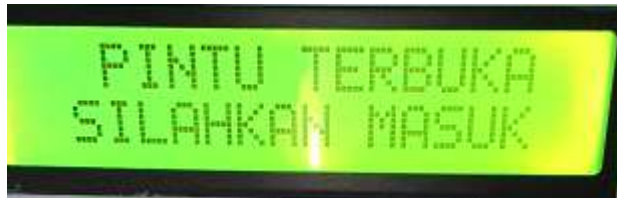
Gambar 50. Tampilan LCD Ketika E-KTP Diakses Mikrokontroler
