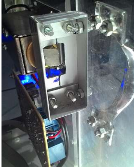
Gambar 54. Solenoid (Off) Menutup Pengunci Pintu
