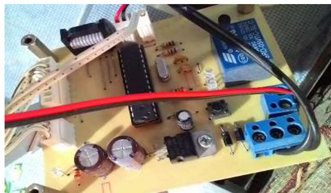
Gambar 42. Board Mikrokontroler ATmega328 (Arduino)
