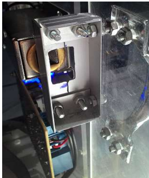
Gambar 53. Solenoid (On) Membuka Pengunci Pintu
