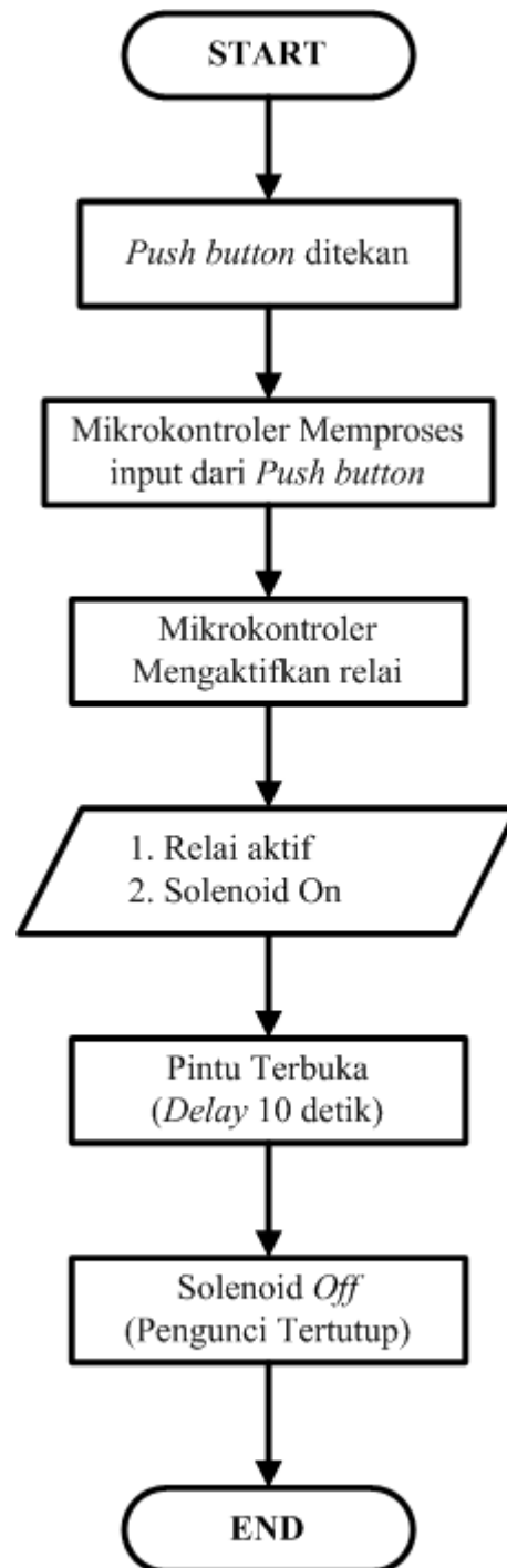
Gambar 24. Flowchart Membuka Pintu Dari Dalam Rumah Menggunakan Push button
