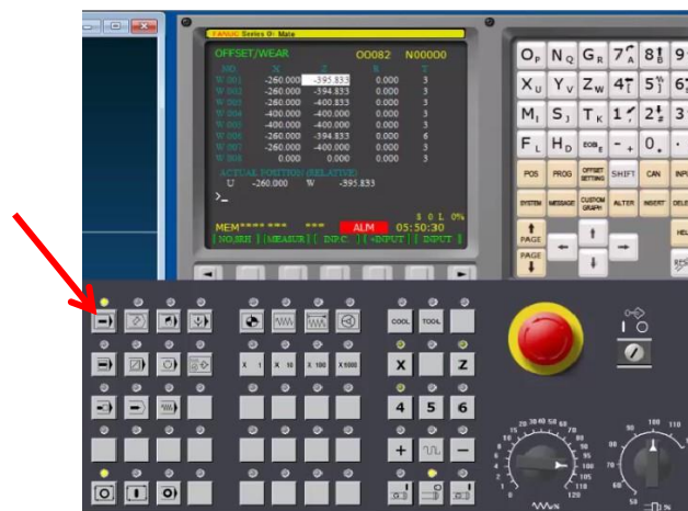
Gambar 2.43 Tampilan simulasi setelah diatur titik nolnya ( offset )
