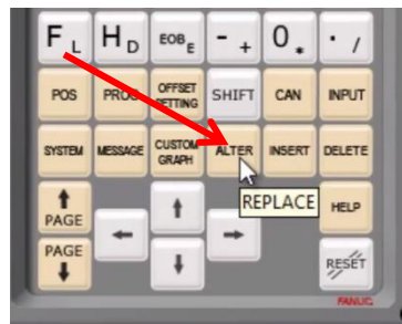
Gambar 2.44 Tombol alter untuk mengganti program
