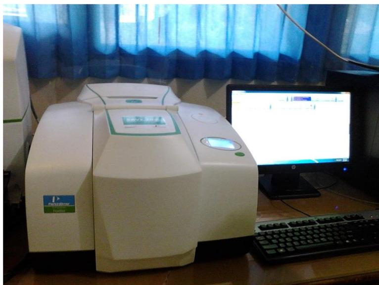
Gambar 5.6 Proses uji spektrum FTIR
