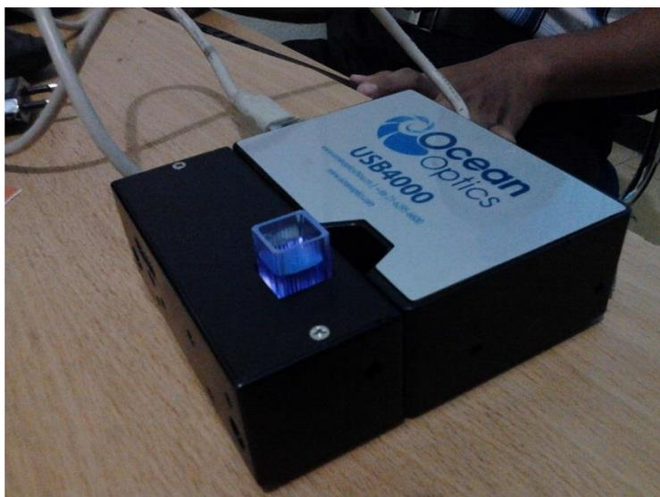
Gambar 5.5 Proses uji spektrum absorbansi.
