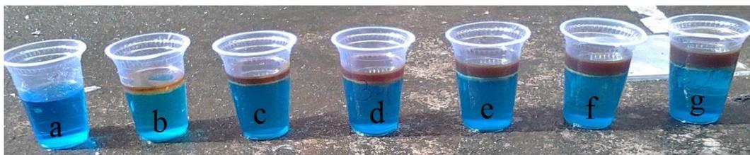
Gambar 4.2 Rangkaian uji fotokatalis terhadap larutan *methylene blue* dengan variasi volume C-Dots (a) 0 ml; (b) 10 ml; (c) 20 ml; (d) 30 ml; (e) 40 ml; (f) 50 ml dan (g) 60 ml.
