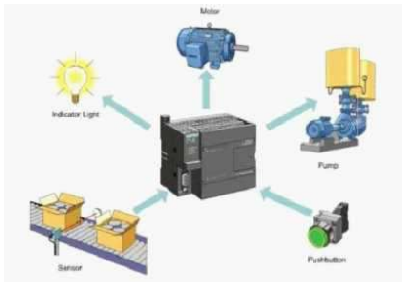
Gambar 2.2 Hubungan PLC dan input/output device
