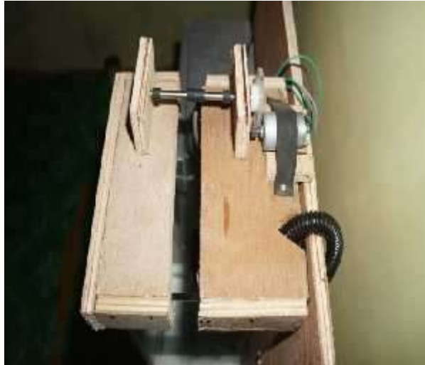
Gambar 3.8 Motor 12 V DC pengangkat mesin pompa air
