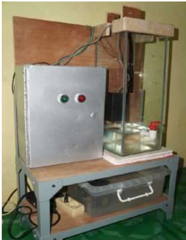
Gambar 3.9 Prototape Unit Pengaman Mesin Pompa Air
