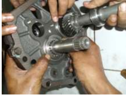
Gambar 3.23. Memasang snap ring
