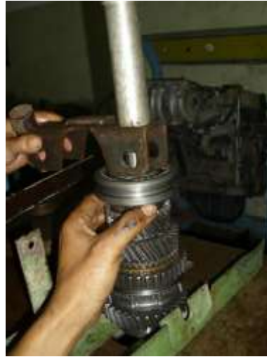
Gambar 3.19. Memasang gigi percepatan dua dan tiga c) Bearing poros output dan gigi percepatan lima pada poros output .
