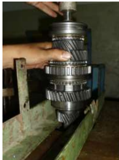
Gambar 3.20. Memasang gigi percepatan lima d) Synchronmesh ring , gigi percepatan empat dan bearing poros input .
