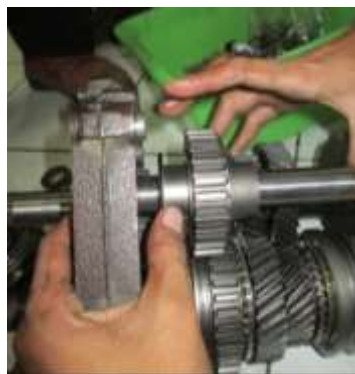
Gambar 3.25. Memasang poros reverse gear
