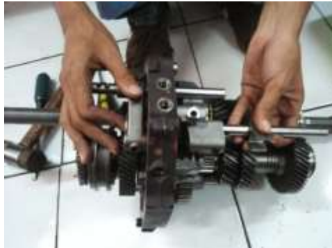
Gambar 3.29. Memasang poros shift fork 3 dan 5
