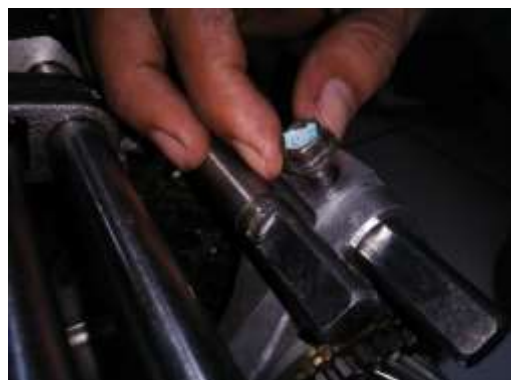
Gambar 3.10. Melepas baut interlock pada shift fork
