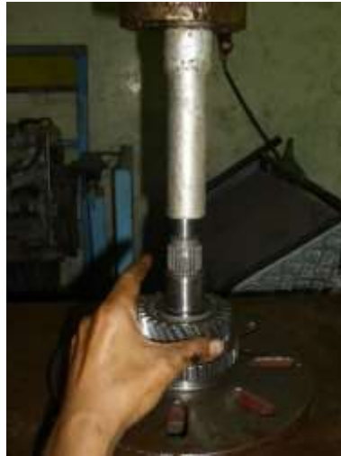
Gambar 3.18. Memasang gigi percepatan satu
