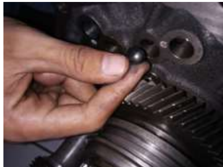
Gambar 3.27. Memasang locking ball
