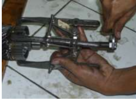
Gambar 3.14. Melepas counter gear lima
