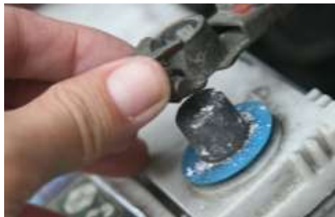
Gambar 3.1. Melepas kabel baterai
