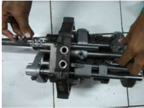
Gambar 3.32. Memasang poros shift fork 1 dan shift fork
