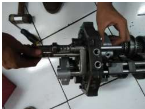
Gambar 3.31. Memasang poros shift fork 2 dan shift fork
