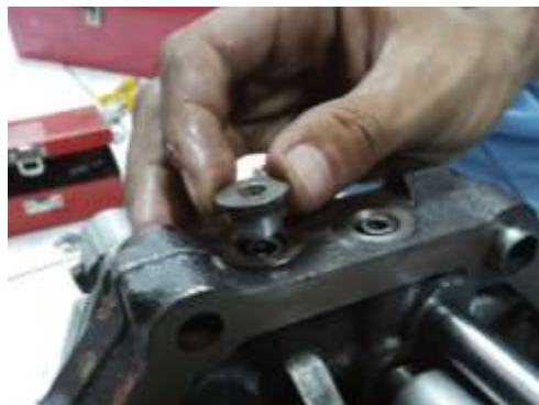
Gambar 3.9. Melepas baut locking ball
