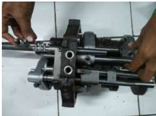
Gambar 3.12. Melepas shift fork shaft
