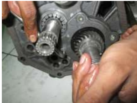
Gambar 3.24. Memasang penutup bantalan poros output
