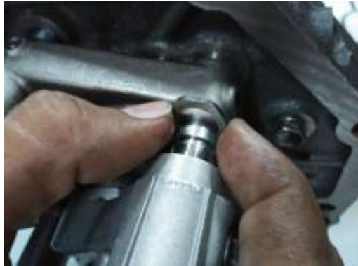
Gambar 3.11. Melepas snap ring pada shift fork
