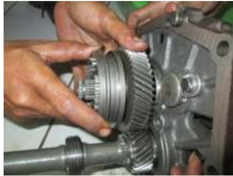
Gambar 3.26. Memasang clutch hub pada poros counter gear
