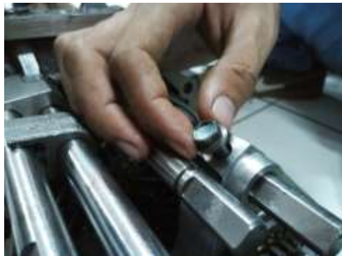
Gambar 3.33. Memasang baut pengunci pada shift fork
