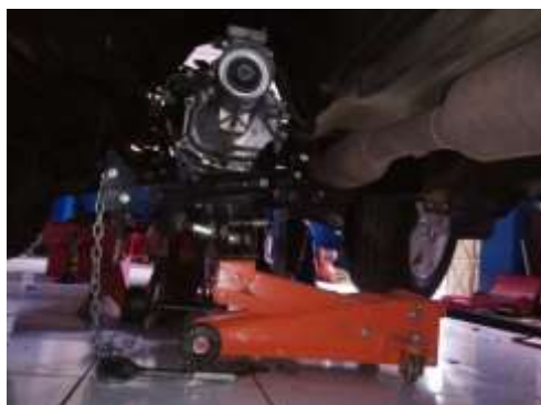
Gambar 3.42. Merakit transmisi pada mesin
