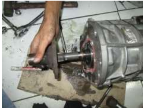
Gambar 3.38. Pemasangan penutup bantalan poros input
