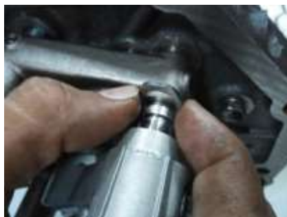
Gambar 3.34. Memasang snap ring pada poros shift fork
