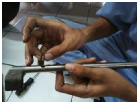
Gambar 3.28. Memasang interlock pin
