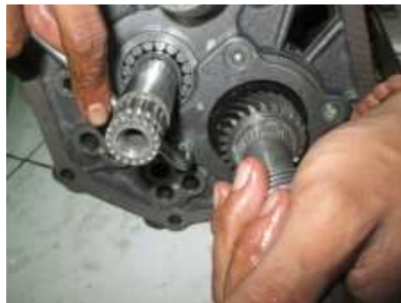
Gambar 3.15. Melepas penutup bantalan main shaft
