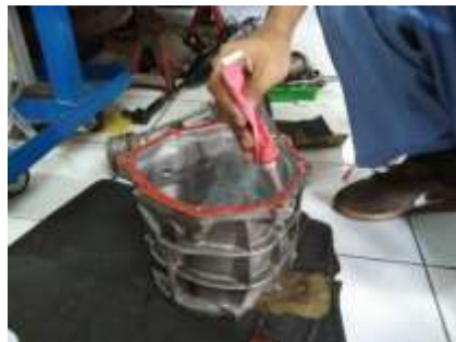
Gambar 3.36. Memberi sealer pada transmission case 18) Memasang transmission case dan extension housing .
