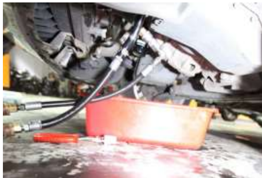
Gambar 3.46. Mengisi oli transmisi
