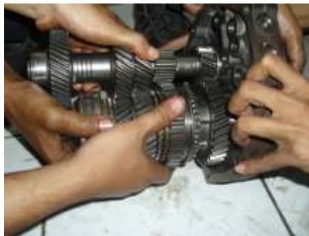
Gambar 3.22. Memasang poros output dan poros counter gear
