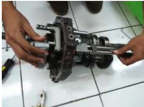
Gambar 3.30. Memasang poros shift fork 4
