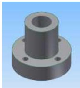
Gambar 22. Model sambungan poros yang akan dipotong menjadi beberapa macam potongan
