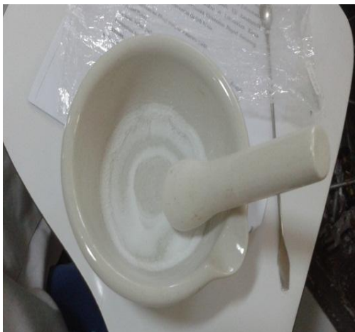
Penggerusan serbuk kasar nanosilika setelah pengeringan dengan oven
