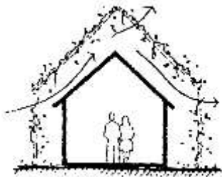
Gambar 4.6 konstruksi pelindung alami melindungi gedung dari panas matahari Sumber : Heinz Frick, 1998
