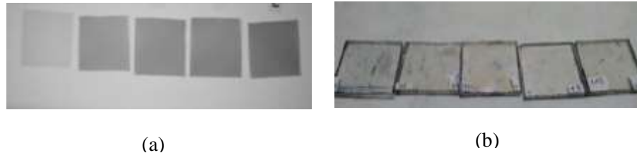
Gambar 4. 1 Sampel variasi konsentrasi (a) hasil ekspose dengan radiografi digital (b) tampak kasat mata
