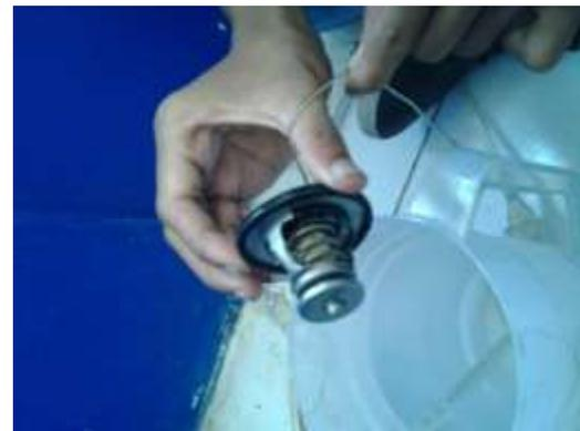
Gambar mengetes katup thermostat
