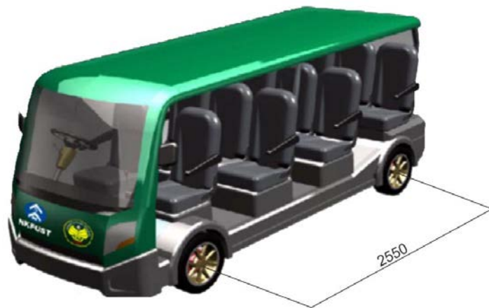
Gambar 4.1 Wheelbase pada mobil listrik angkutan massal Unnes
