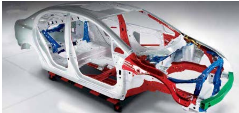
Gambar 2.2 Konstruksi Bodi Integral ( Monocoque Body )
