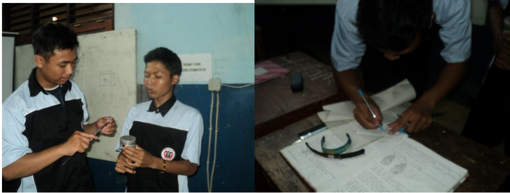
Gambar 10. Siswa Mengukur Piston dengan Jangka Sorong
