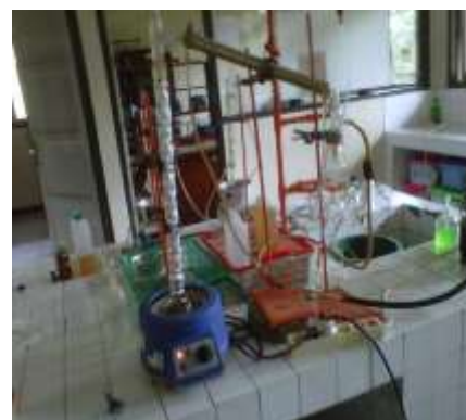
Destilasi penurunan tekanan etil asetoasetat
