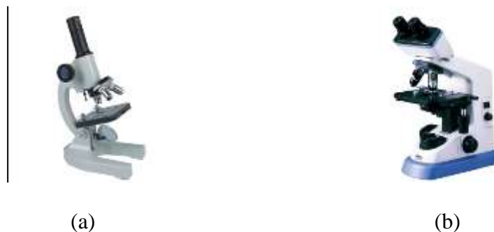
Gambar 2.1 Mikroskop cahaya, (a) monokuler dan (b) binokuler
