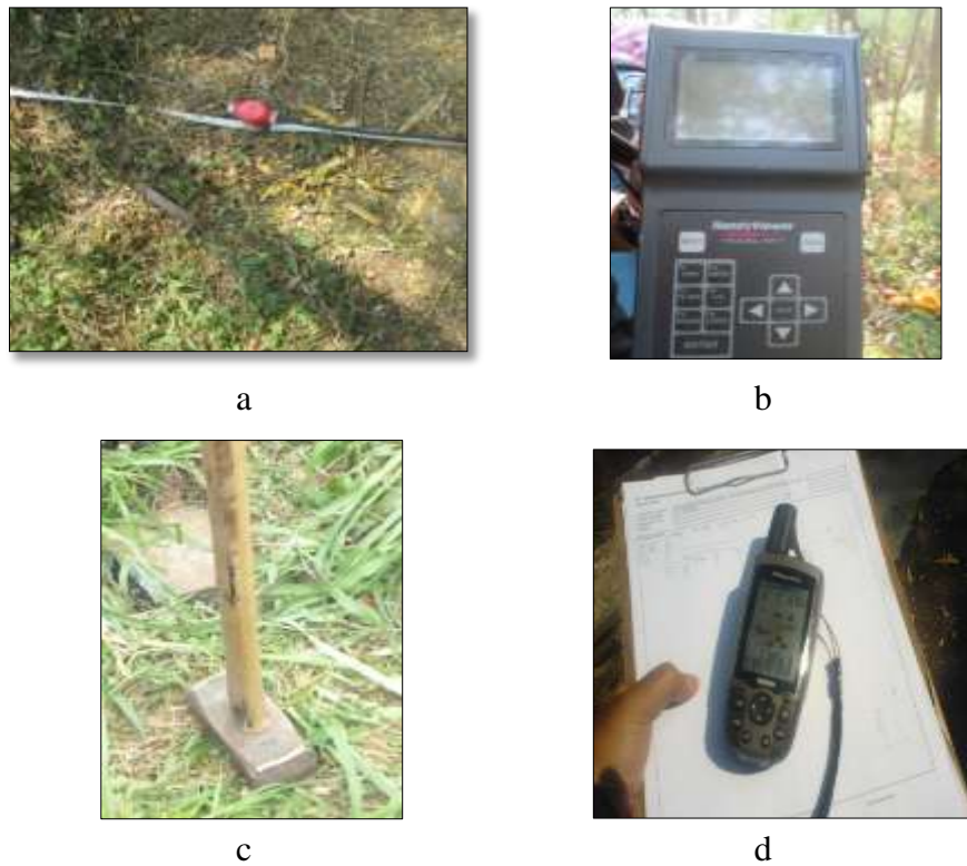
Gambar 2.9 Alat seismik refraksi (a) Geophone (b) seismograph OYO McSeis-SX 3 chane (c) bantalan baja dan palu (d) GPS dan alat tulis
