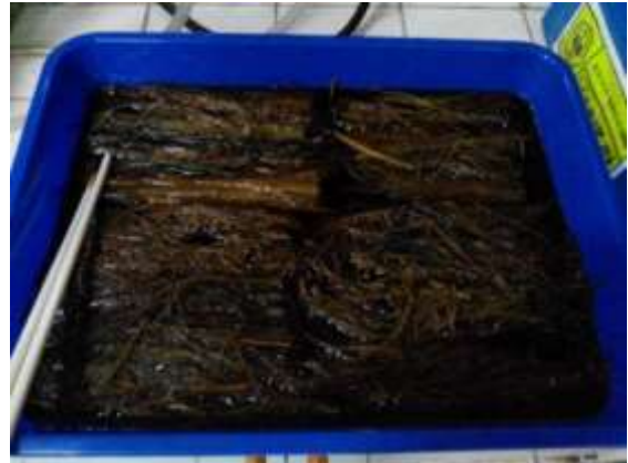
Serat batang pisang saat perlakuan alkali
