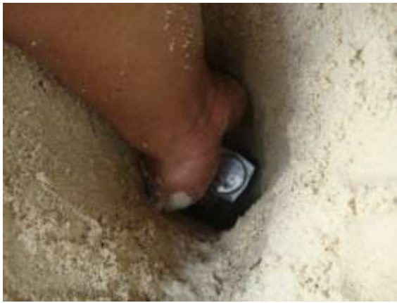
Gambar Menancapkan soil meter ke dalam tanah.
