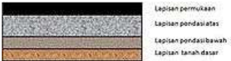
**Gambar 2.1. Susunan Konstruksi Perkerasan Lentur**
