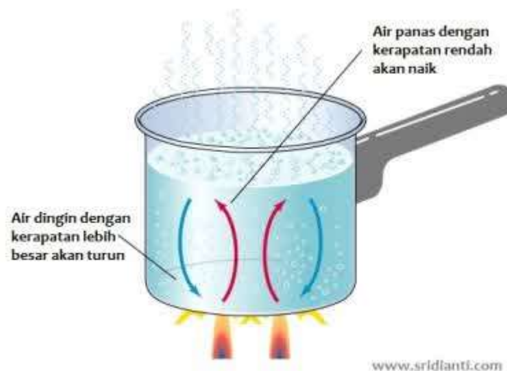
Gambar 1.3 Pemanasan Air untuk Menggambarkan Perpindahan Kalor Secara Konveksi
