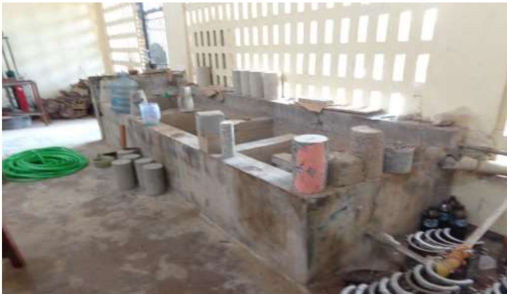
Gambar 3. Papan dalam rendaman air untuk pengujian pengembangan tebal setelah direndam air
