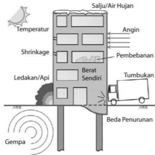
Gambar 2.4 Pembebanan pada Bangunan Gedung
