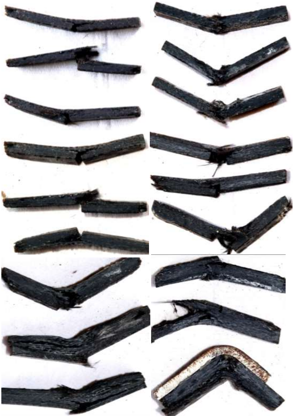
Bentuk Patahan Serat Karbon Setelah Diuji
