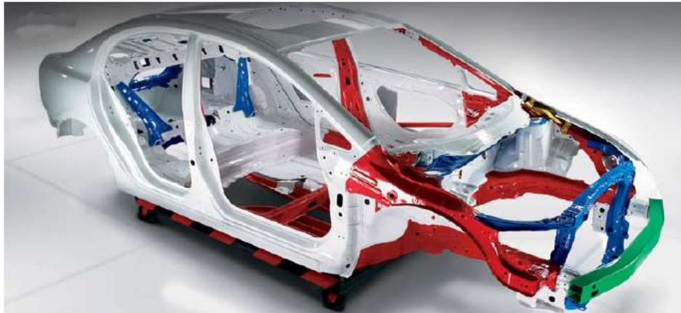
Gambar 8. Kontruksi Bodi Integral ( Monocoque Body ).
