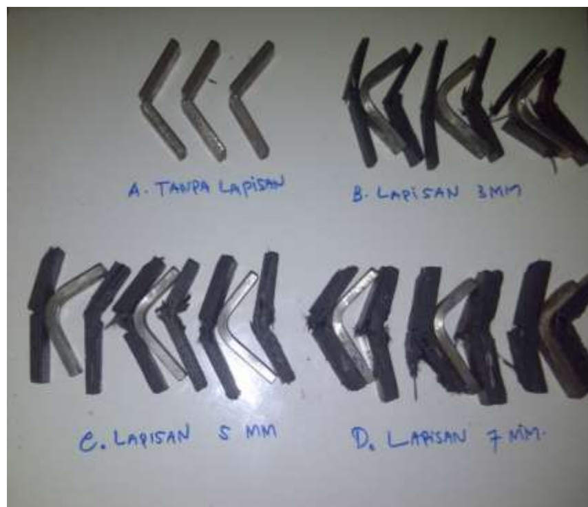
Gambar Setelah Dilakukan Pengujian Impact
