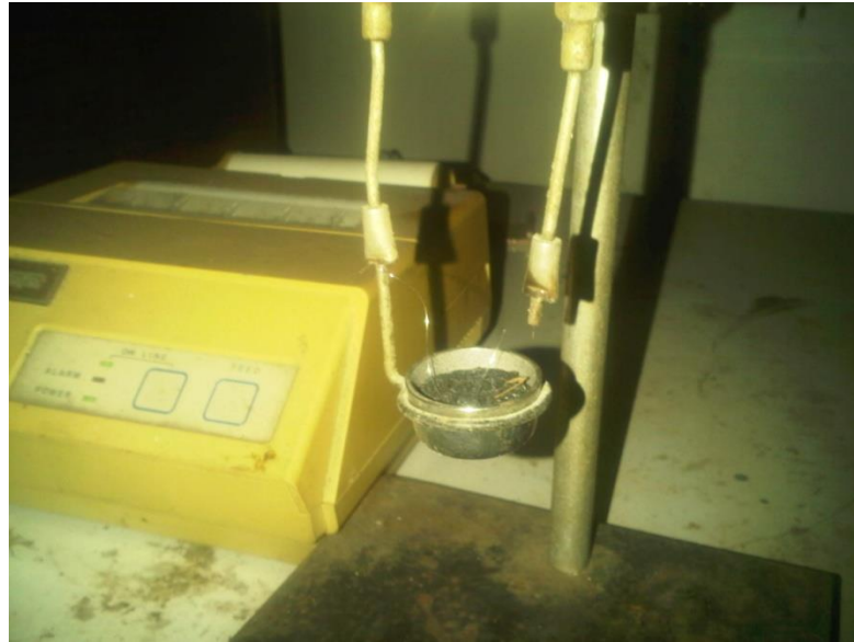
kawat pembakaran sepanjang 10 cm yang sudah terpasang
