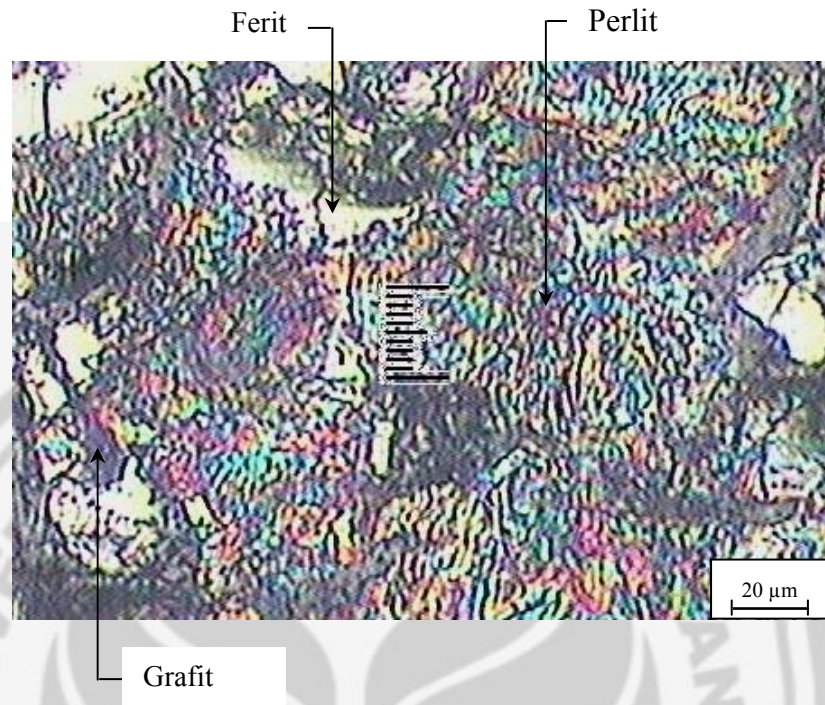
Gambar 41. Struktur mikro logam induk pengelasan PWHT 600 0 C
