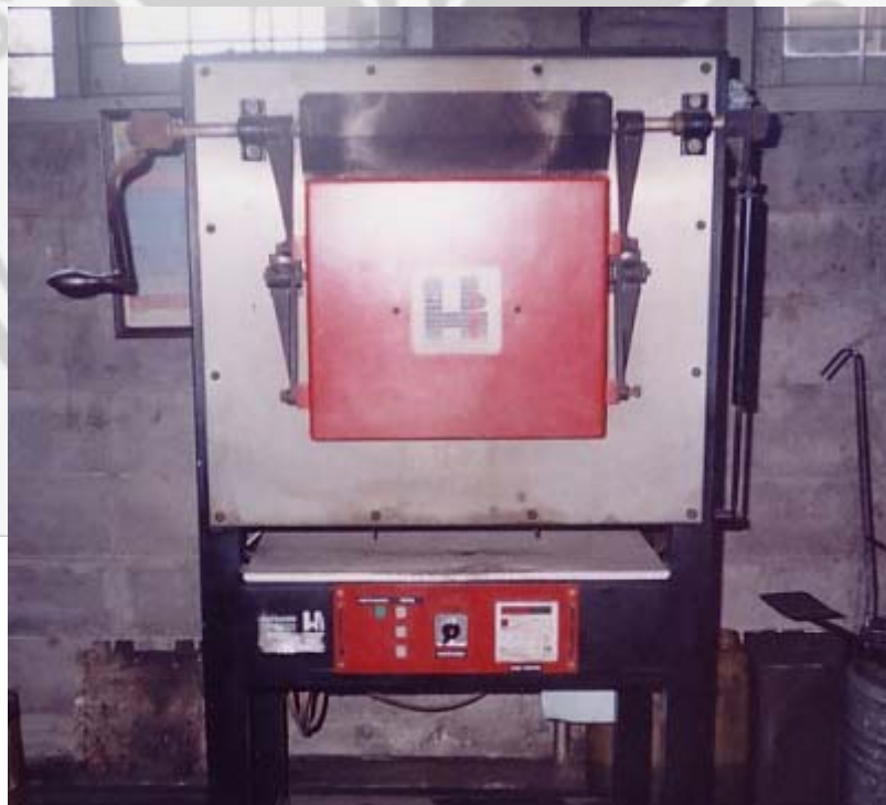
Gambar 10. Oven pemanas logam merk hofmann
