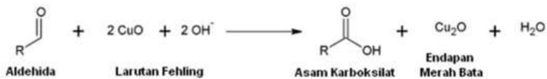
Gambar 2.2. Reaksi pada Uji Fehling
