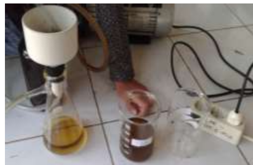
Gambar L.7. Filtrasi menggunakan corong buchner & pompa vakum
