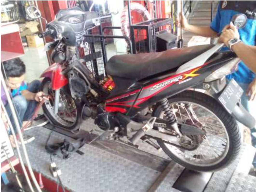
Gambar 3. Instalasi sepeda motor pada dynamometer
