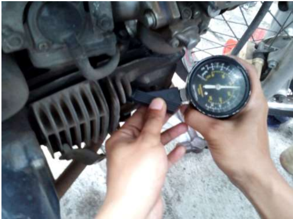
Gambar 4. Pengukuran tekanan kompresi
