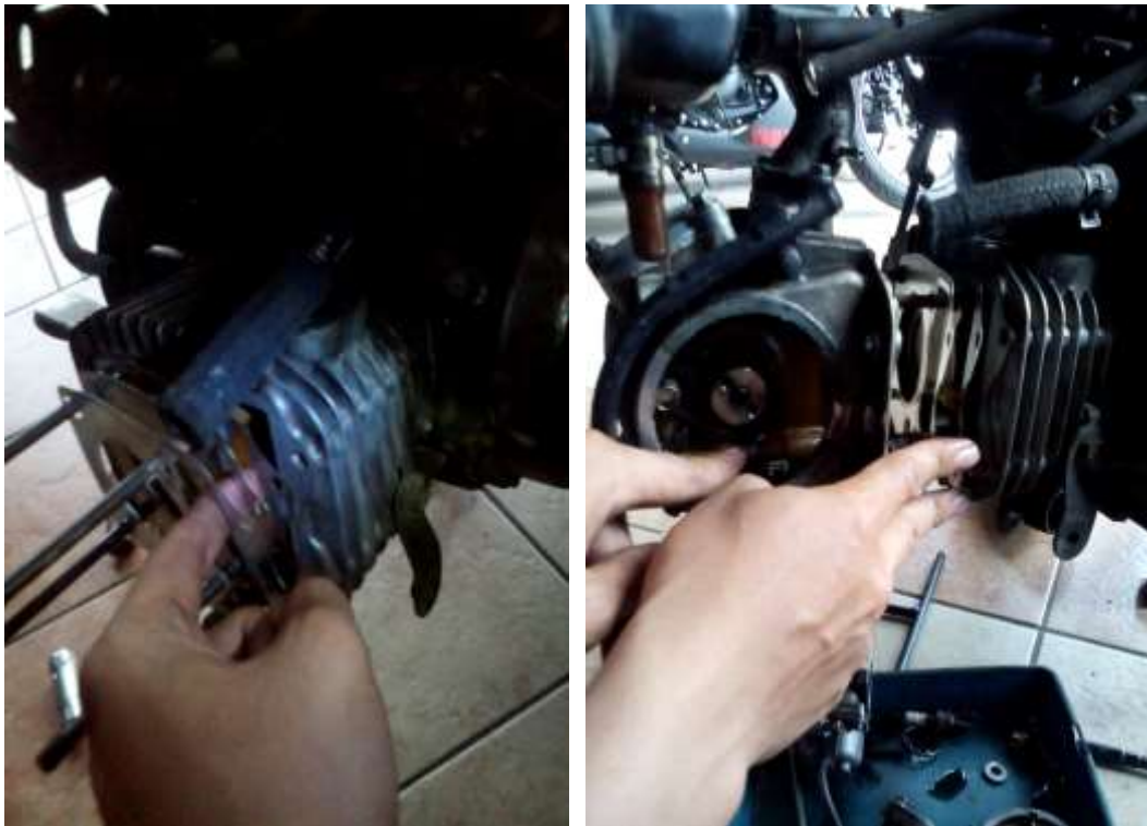
Gambar 5. Proses penambahan gasket pada kepala silinder
