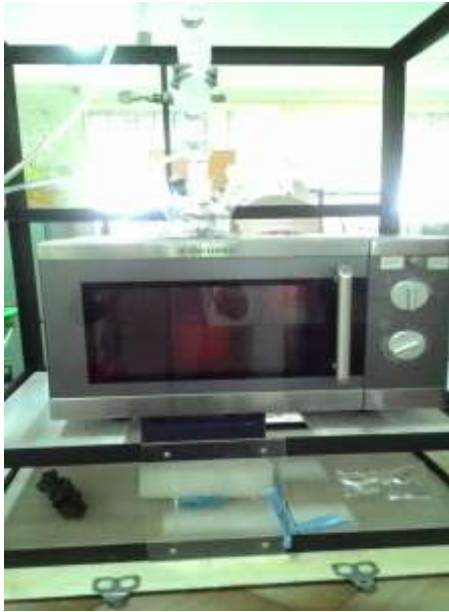
Gambar 3. Pembuatan Biodiesel Dengan Microwave
