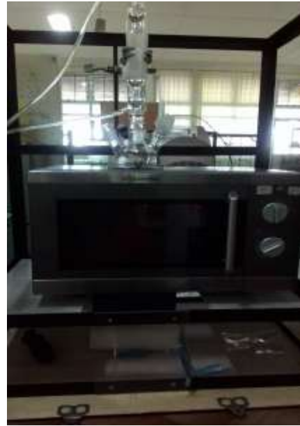
Gambar 3. Pembuatan Biodiesel Dengan Microwave
