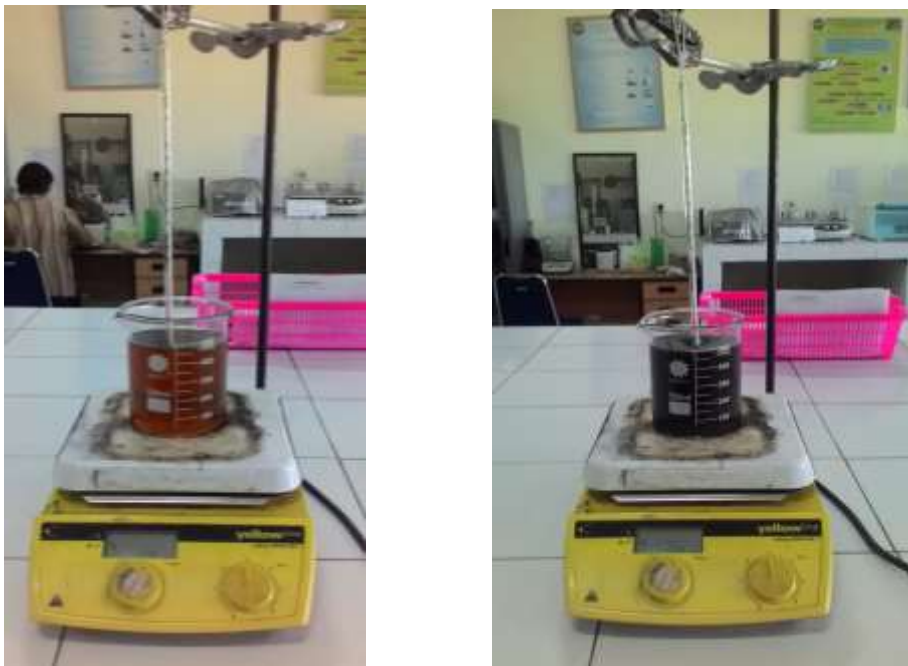
Gambar 1. Proses bleaching minyak jelantah
