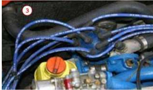
Gambar 2.10 Jenis kabel untuk sistem pengapian pada mobil
