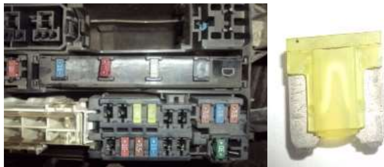
Gambar 2.4 Sekring ( fuse ) pada Toyota Kijang Innova Tipe G
