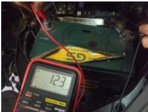
Pengukuran baterai sesuai dengan spesifikasi
