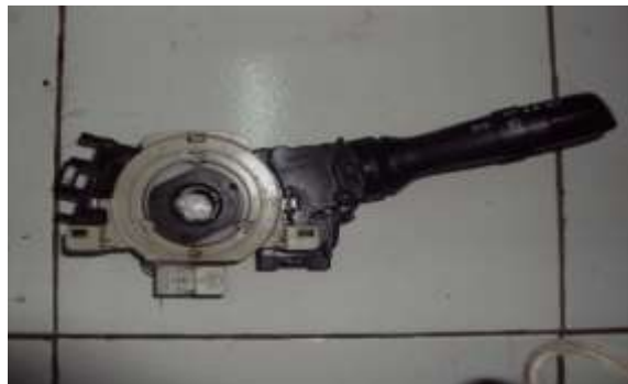
Gambar 2.6 Switch tuas pada Toyota Kijang Innova Tipe G
