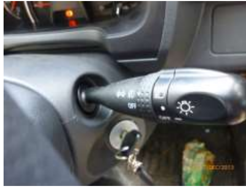
Gambar 2.7 Switch tuas pada mobil Toyota Agya
