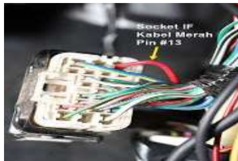
Gambar 2.9 Kabel konektor pada lampu kepala Toyota Kijang Innova
