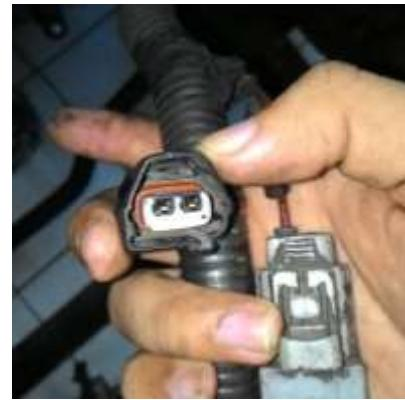
Gambar Memeriksa Terminal pada Konektor *Camshaft Position Sensor*
