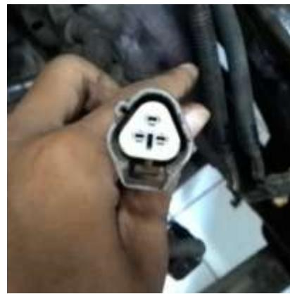
Gambar Memeriksa Terminal pada Konektor *Crankshaft Position Sensor*
