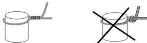
Gambar 16. Pemasangan rol isolator.
