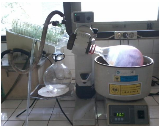
b. Proses evaporasi dengan rotary vacuum evaporator
