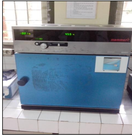
Pengeringan antimicrobial film menggunakan oven 40°, 24 jam
