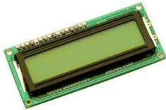
**Gambar 2.8** Bentuk Fisik LCD
