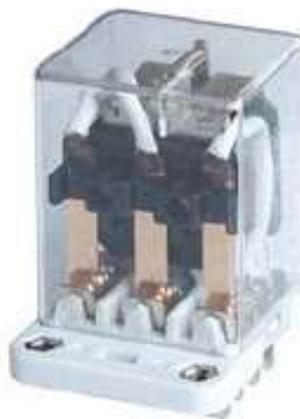
**Gambar 2.12** Bentuk Fisik *Relay*
