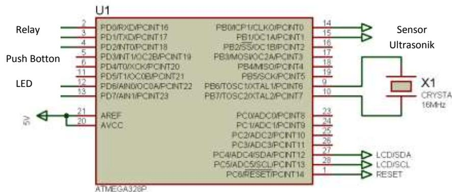
Gambar 3.3Rangkaian Mikrokontroller Atmega 328
