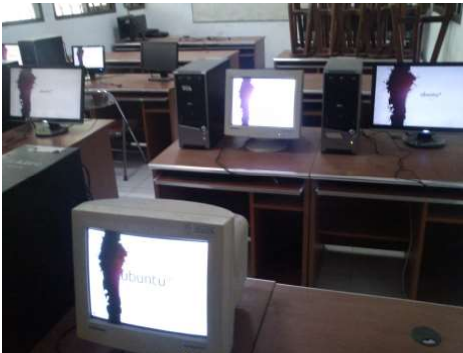
Hasil Jadi Sistem Jaringan Komputer Diskless Berbasis LTSP dengan Sistem Operasi Linux Ubuntu 14.04 LTS
