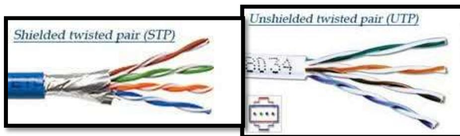
**Gambar 2.14.** Kabel STP dan UTP
