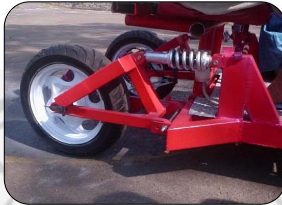
Gambar 20. Konstruksi sistem suspensi belakang Micro Car
