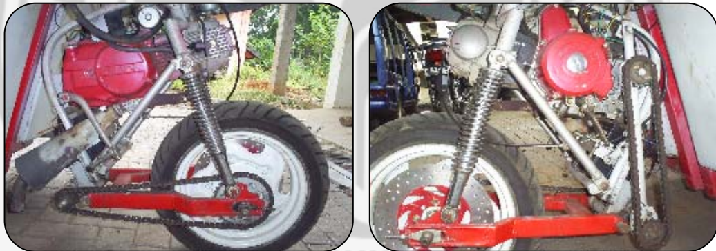
Gambar 18. Konstruksi sistem suspensi depan Micro Car
