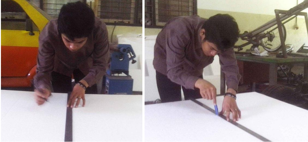
Membuat pola cetakan bodi pada styrofoam
