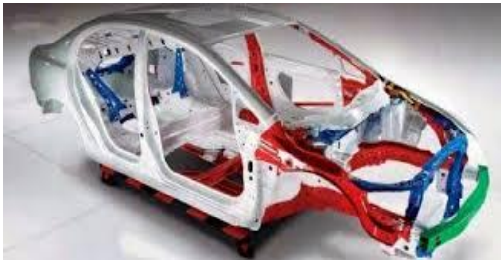
Gambar 5. Kontruksi Bodi Integral ( Monocoque Body ) (Tim Fakultas Teknik Universitas Negeri Yogyakarta. 2004. Perkembangan Bodi Kendaraan)
