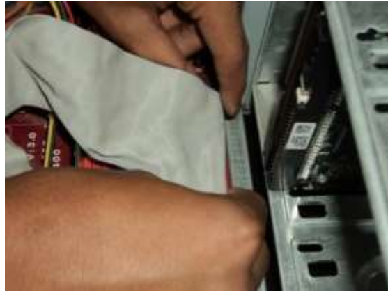
Gambar 2.20 Memasang Kabel IDE pada Drive
