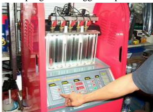
Gambar 7. Pengaturan leakage test Injector tester Sumber.Job Sheet. Workshop.Teknik Mesin Unnes
