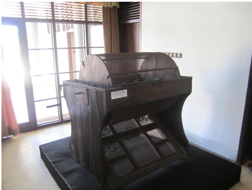
Alat Pembersih/Penyaring Tembakau Tradisional (Kronde) dari PR. SOGO (Dokumentasi pribadi, 12 November 2012)
