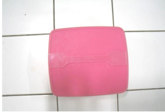
Cetakan / pola sampel uji kuat tarik
