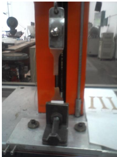
Alat kuat tarik dan elongasi, serta proses pengujiannya
