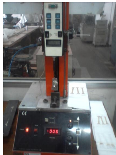
Alat kuat tarik dan elongasi, serta proses pengujiannya
