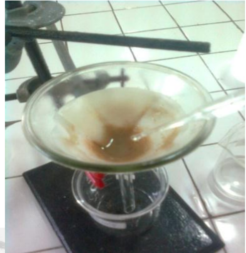
11. Pemurnian presipitat dengan etanol 96%
