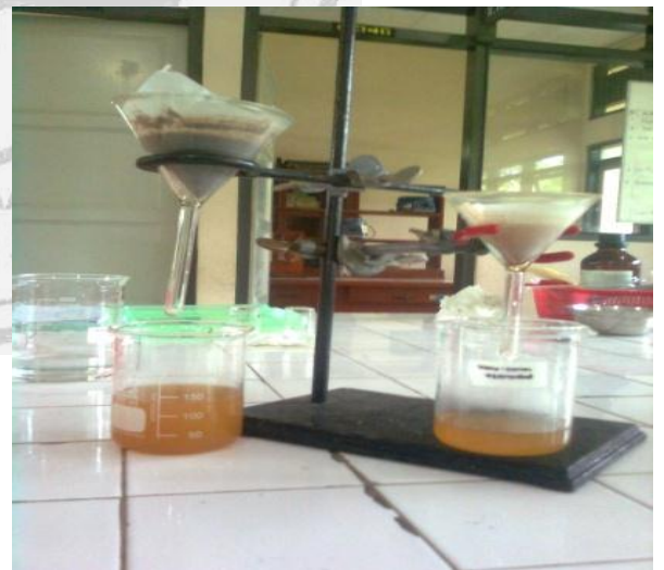
4. Penyaringan ekstrak serbuk kulit pisang kepok
