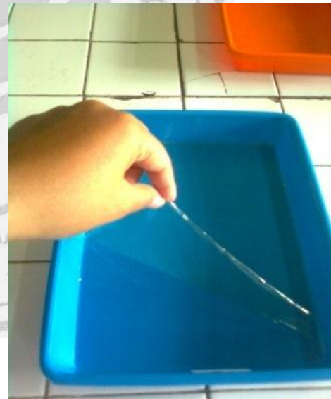
8. Melepaskan edible film dari cetakan
