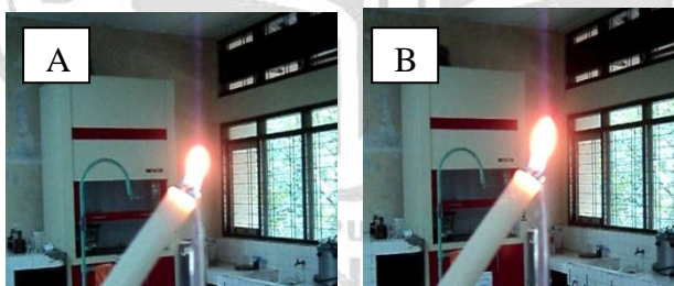
Gambar 4.16. Uji hidrogen secara kualitatif dengan menggunakan nyala api (A) Sebelum kran dibuka, (B) setelah kran dibuka
