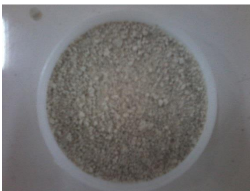
Pasir putih teraktivasi asam sulfat (PA1)
