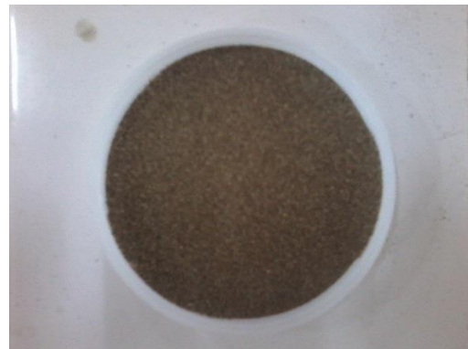
Pasir hitam teraktivasi asam sulfat dan tersalut feri oksida (HA3)
