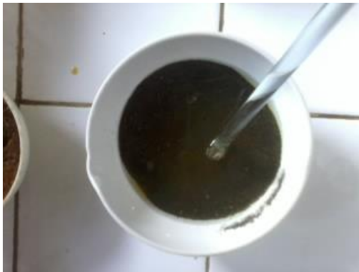
Aktivasi pasir laut menggunakan Asam sulfat
