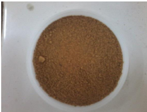
Pasir putih teraktivasi asam sulfat dan Tersalut feri oksida (PA3)
