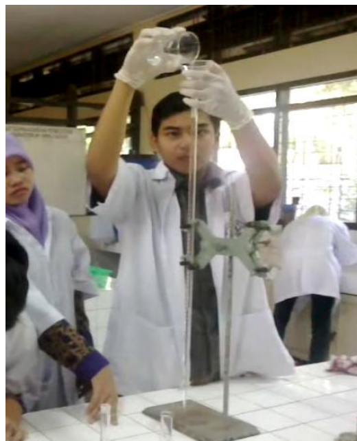
Gambar 5. Mahasiswa Menuang Larutan ke dalam Buret
