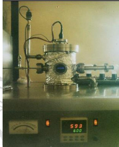
Proses Deposisi Film Tipis di dalam Chamber
