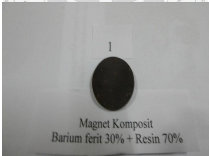
Gambar 4.1. Foto Permukaan magnet komposit barium ferit 30% + Resin 70%
