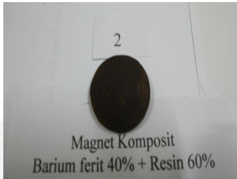
Gambar 4.2. Foto Permukaan magnet komposit barium ferit 40% + Resin 60%
