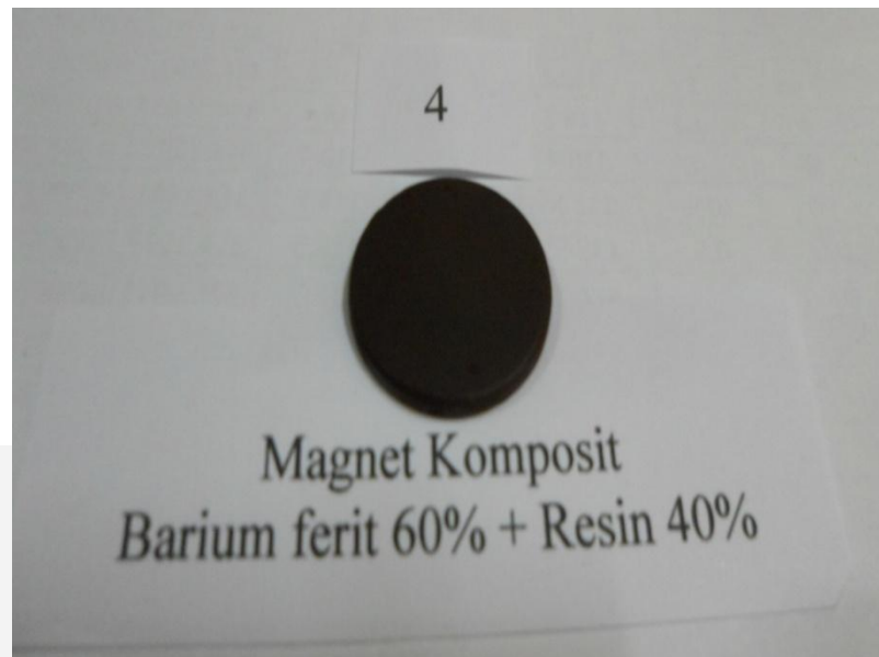
Gambar 4.4. Foto Permukaan magnet komposit barium ferit 60% + Resin 40%
