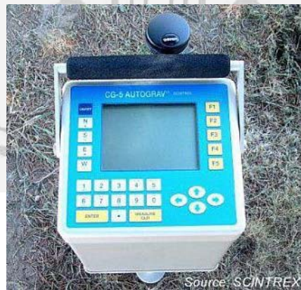
Gambar 3.2 Gravimeter Scintrex Autograv CG-5
