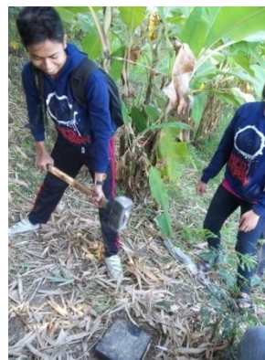
6. Membuat sumber gelombang dengan palu pasak bumi yang dipukulkan pada landasannya
